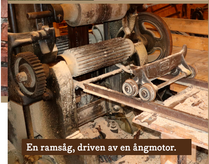
De gamla maskinerna är i drift med hjälp av remdrift.
