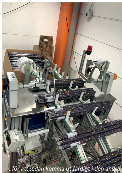
Stora rullar (ca 500 kg) med presentpapper laddas i ena änden av maskinen...
