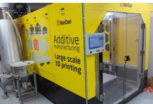
NorDan har införskaffat en 3D skrivare som "skriver ut" nästan vilka fönsterdelar som helst i trägranulat.
