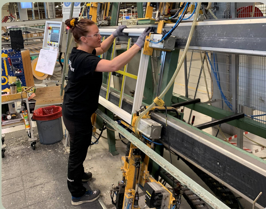
Sara Stridh spikar ihop MF båge på Vetlanda 1 fabriken på Elitfönster. Läs mer på sida 8 och framåt.
